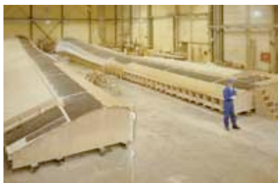
Die 56 m langen Rotorblätter der Enercon E-112 werden derzeit bei der im Formenbau erfahrenen Abeking & Rasmussen Rotec in Lemwerder gefertigt.
