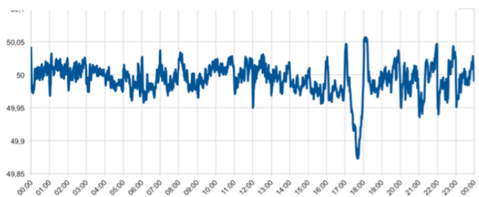
Abbildung 2: Netzfrequenz Deutschland während des plötzlichen Ausfalls eines Braunkohlekraftwerkes (Quelle: Netzfrequenz.info)
